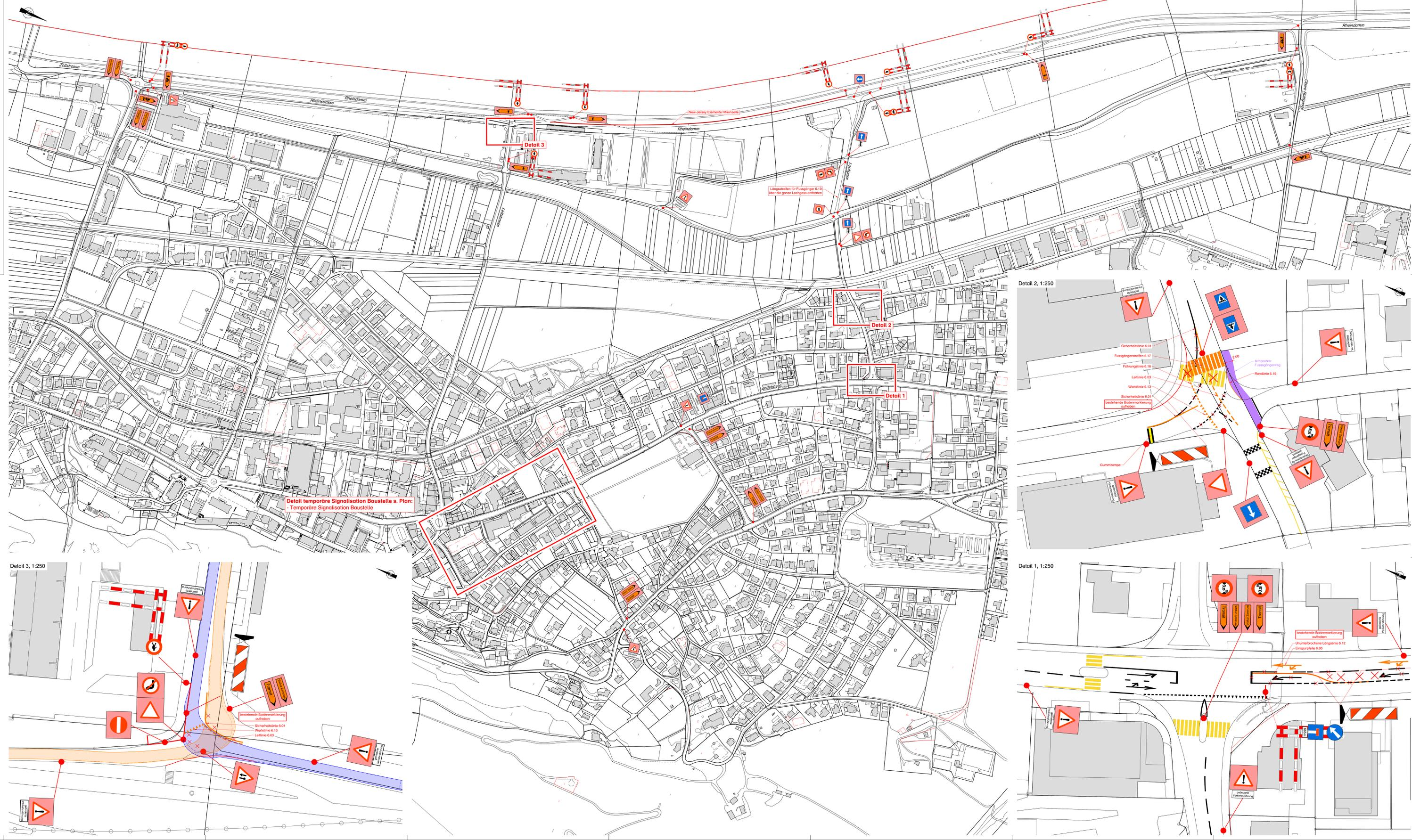
Die Ausführung, Ausgestaltung und das Anbringen der Signalisation, Abzeichnung und Beleuchtung richtet sich nach der Strassenverkehrsverordnung SRV sowie der Schweizer Norm SN 40 886 "Baustellen; Signalisation von Baustellen auf Haupt- und Nebenstrassen".
