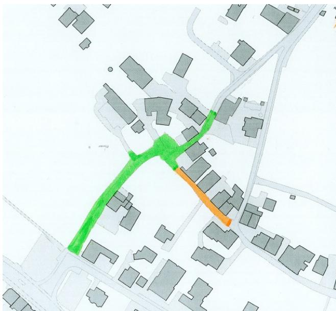
1. Es wurde im Verlauf der Bauarbeiten festgestellt, dass sich die Abwasserleitung vom Torkelplatz Richtung Kasperigass auf Grund ihres Alters (Baujahr 1952) in einem schlechten Zustand befindet. Diese wurde bei der Sanierung des „Truubagässli“ 1991 nicht saniert. Um die Betriebssicherheit der Abwasserleitung gewährleisten zu können und zeitnahe Grabarbeiten in diesem Bereich auszuschliessen, soll diese Leitung im Zusammenhang mit dem Bauprojekt Hintergass erneuert werden.
