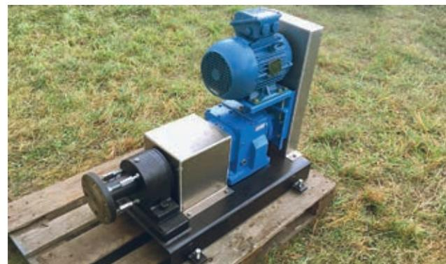
Die neue Schneckenpumpe für das Drainagepumpwerk im Vaduzer Riet.
