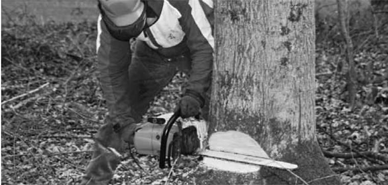
*Mit der Fallkerbe bestimmt der Forstwart die Fallrichtung.*
